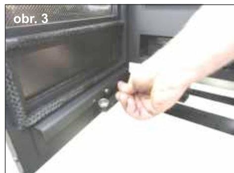
Demontáž táhla dvířek z vodící lišty
