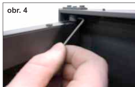
Demontáž pojistného kroužku
